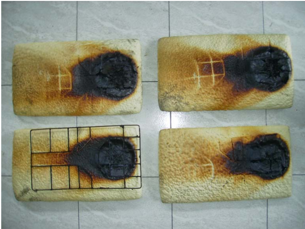
Aspecto de la muestra tras el ensayo de epirradiador según norma UNE 23721:1990
